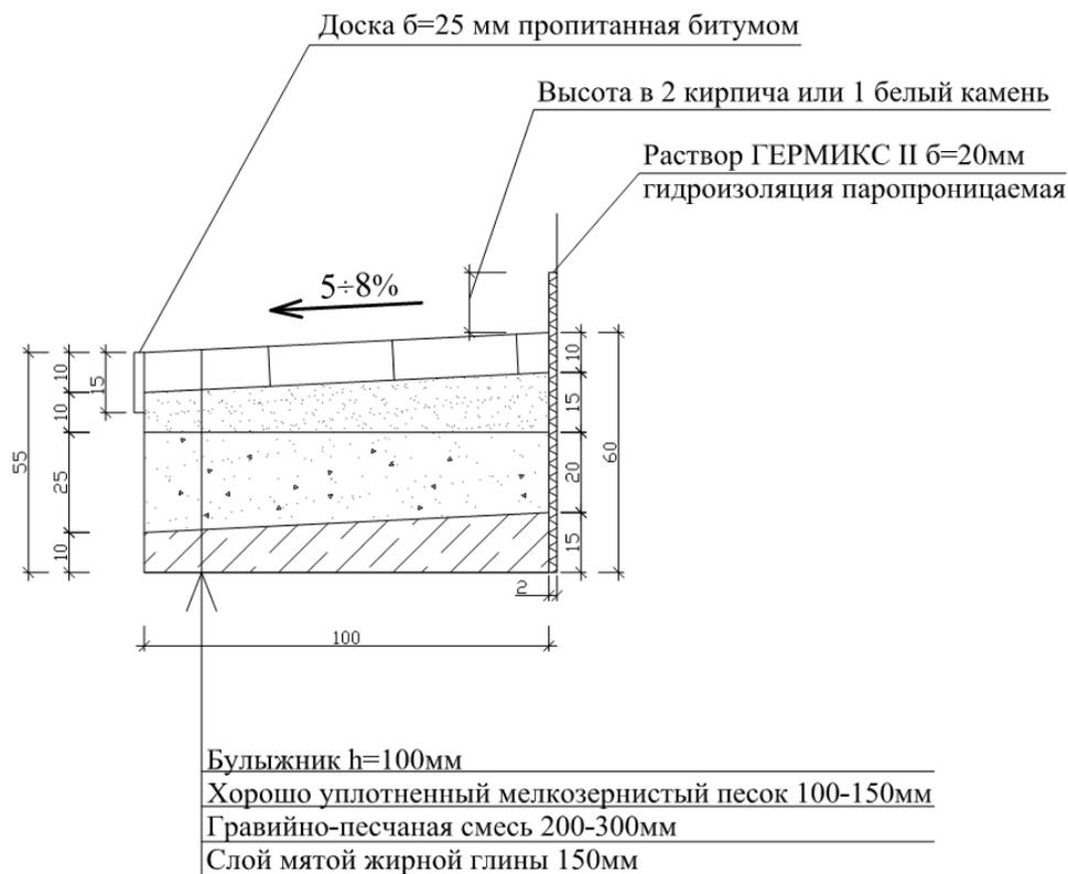
Рис. 3.1 Устройство дискретной отмостки
