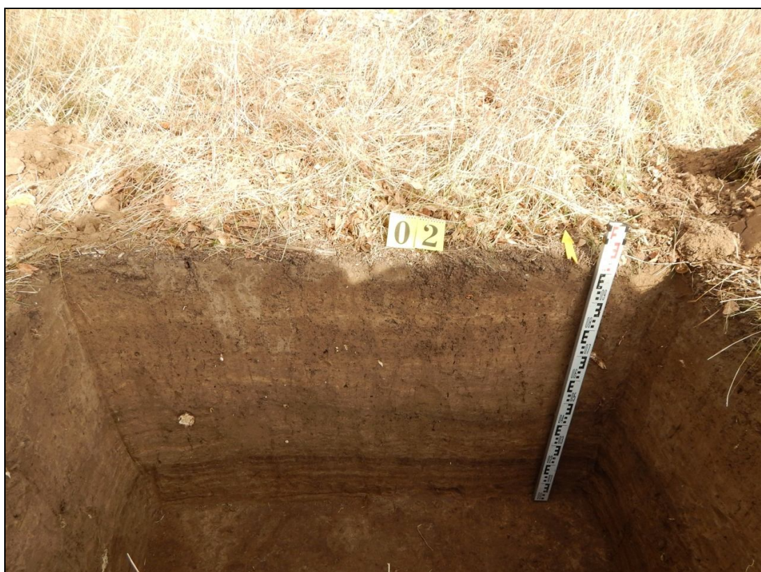
Илл. 37. Рекогносцировочный шурф № 2. Профиль северной стенки.
