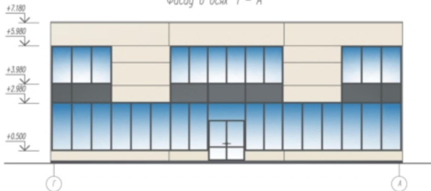
Фасад в осях "Г"-"А"
