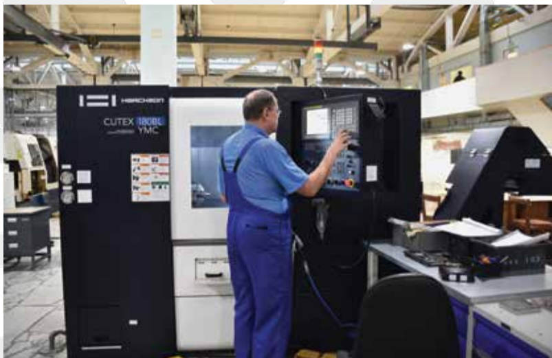
Токарно-обрабатывающий центр с ЧПУ в цехе № 103
