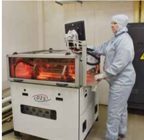
Установка бесштифтового совмещения слоёв в цехе № 108
