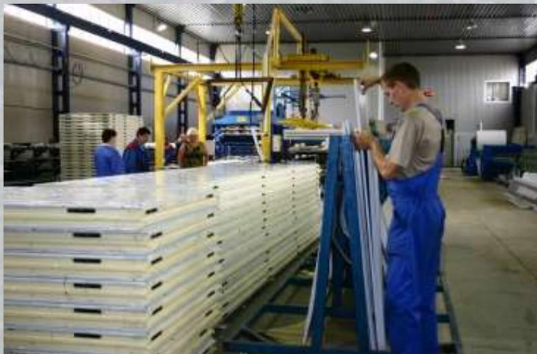
*Производство сэндвич панелей с наполнителем PIR непрерывным способом.*
