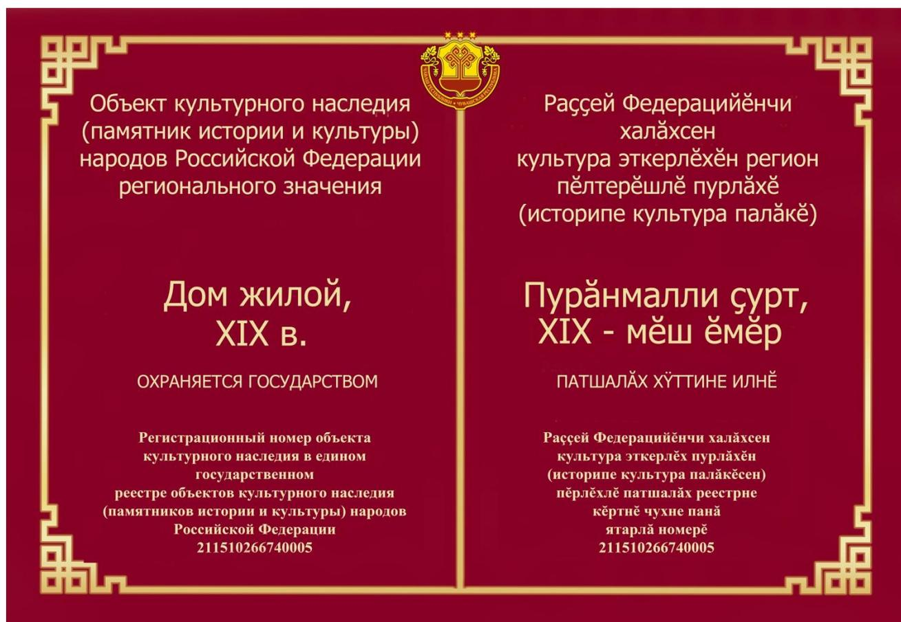
Информационная надпись располагается на фасаде здания справа от входа на уровне второго этажа. Изготавливается в виде пластины из композитного материала габаритным размером 800х600 мм. Надпись об объекте культурного наследия наносится методом аппликации (плоттерная нарезка самоклеющейся пленки AVERY), шрифт - Tahoma, размере шрифта 44п.
