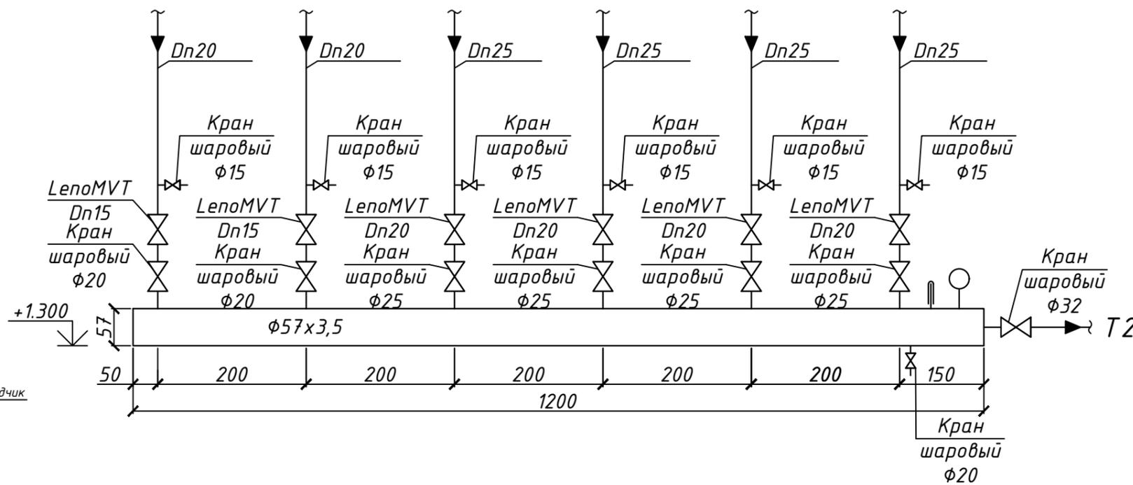
Схема подключения секционного радиатора
