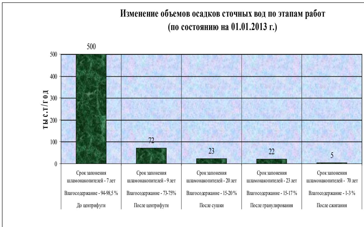
*Рис.3.7. Изменение объемов осадков сточных вод по этапам работ*
