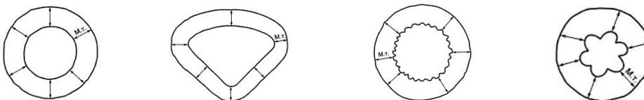
В соответствии с ГОСТ 31996-2012 (общие технические условия) на кабели силовые введено понятие среднего значения толщины изоляции. Среднее значение толщины изоляции должно быть не менее номинального значения.
