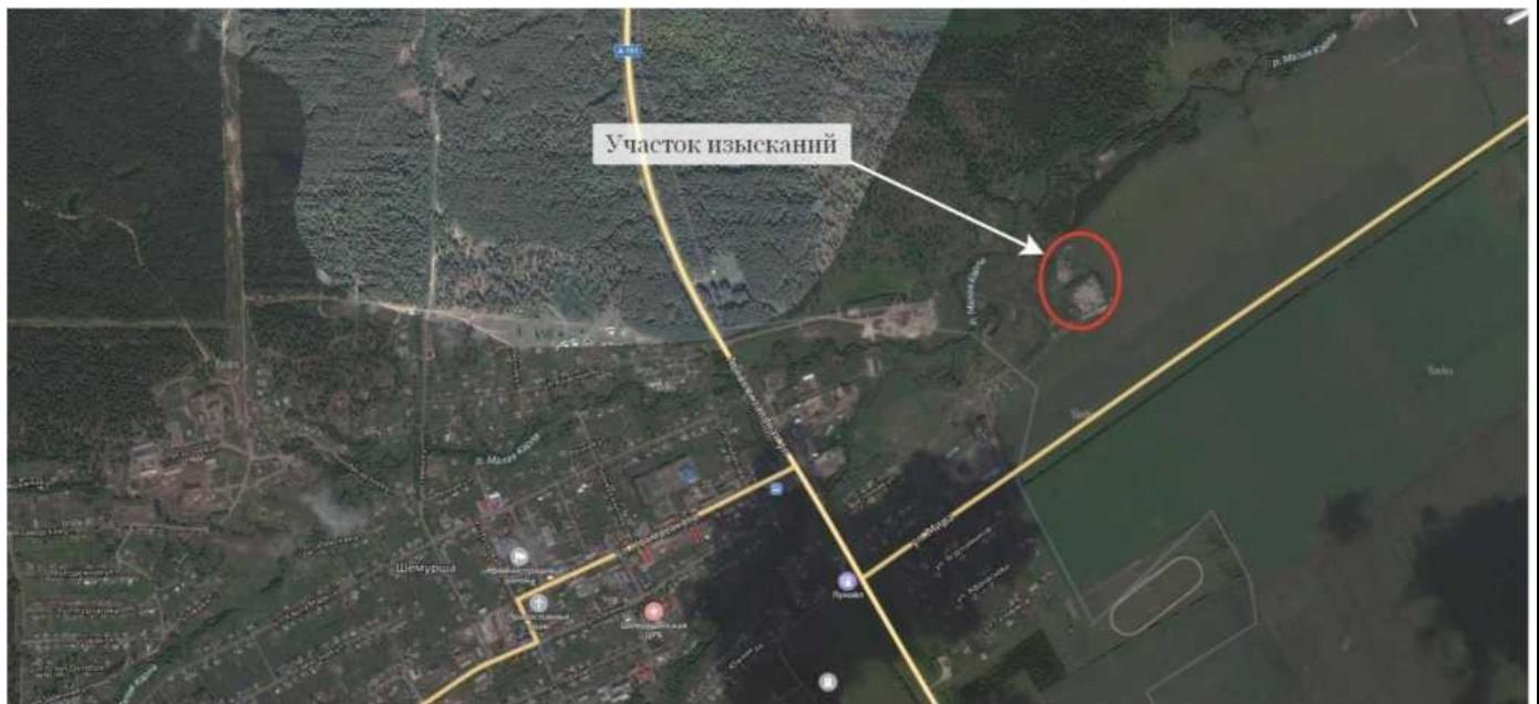
м. Вдоль долины реки выполнено обвалование глинистым грунтом. Площадка санкционированной свалки квадратной в плане формы, размерами 140 x 140 м, обвалована местными глинистыми грунтами  $h = 1-2$  м), абсолютные отметки поверхности основания – 51-147,5 м, отметки поверхности ТБО – 150,4-148 м. С юго-запада, со стороны села, подходит грунтовая автодорога по насыпи высотой 1 м. Вдоль южной и северной границ растут деревья (береза, ива и пр.).
